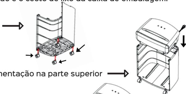
2. Encaixe o mecanismo de fragmentação na parte superior da estrutura da fragmentadora.
